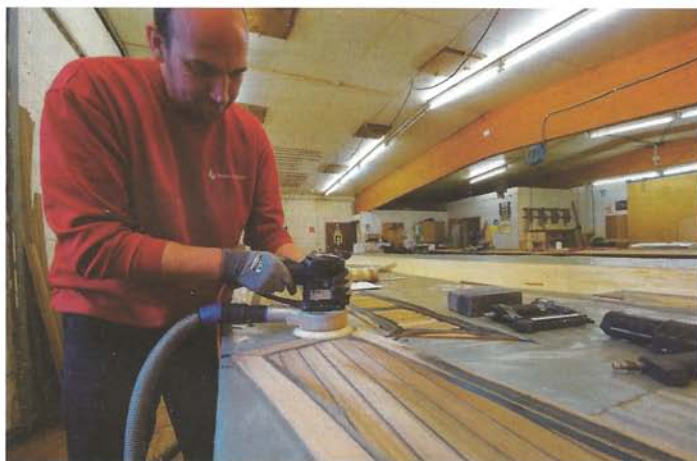
Präzisionsarbeit: Tischler Kolya Maskos schleift mit dem Exzenterschleifer übergequollene Fugenmasse vom Holz. Die vorgefertigten Teak-Decks lassen sich nur in Handarbeit herstellen.
